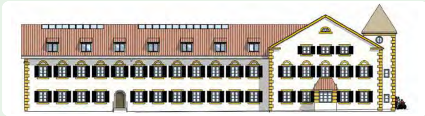
Sichtbare Veränderung auch von außen: Schleppgauben und Firstverglasungselemente sorgen künftig für mehr Licht im Dachgeschoss des Rathauses. Bildquelle: Architekturbüro Seemayer
