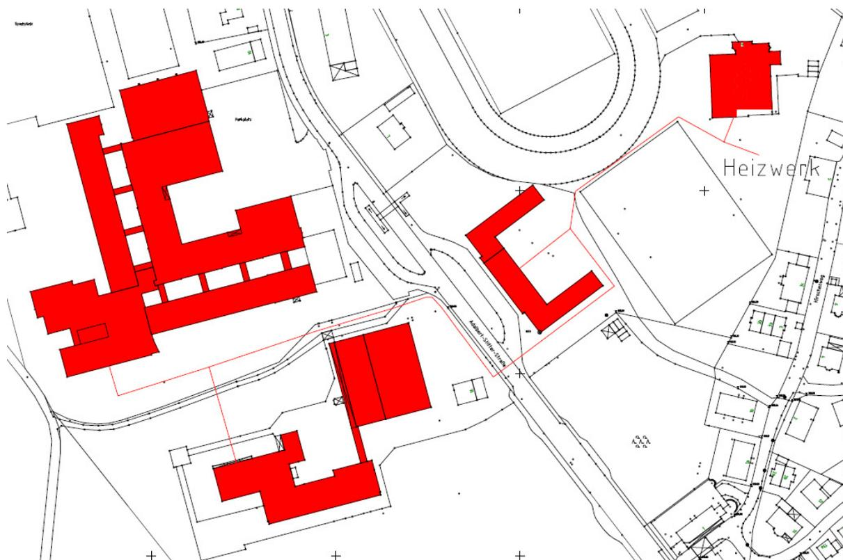
**Abbildung 108: Der mögliche Verlauf des Nahwärmeverbundnetz „Schulzentrum“**
