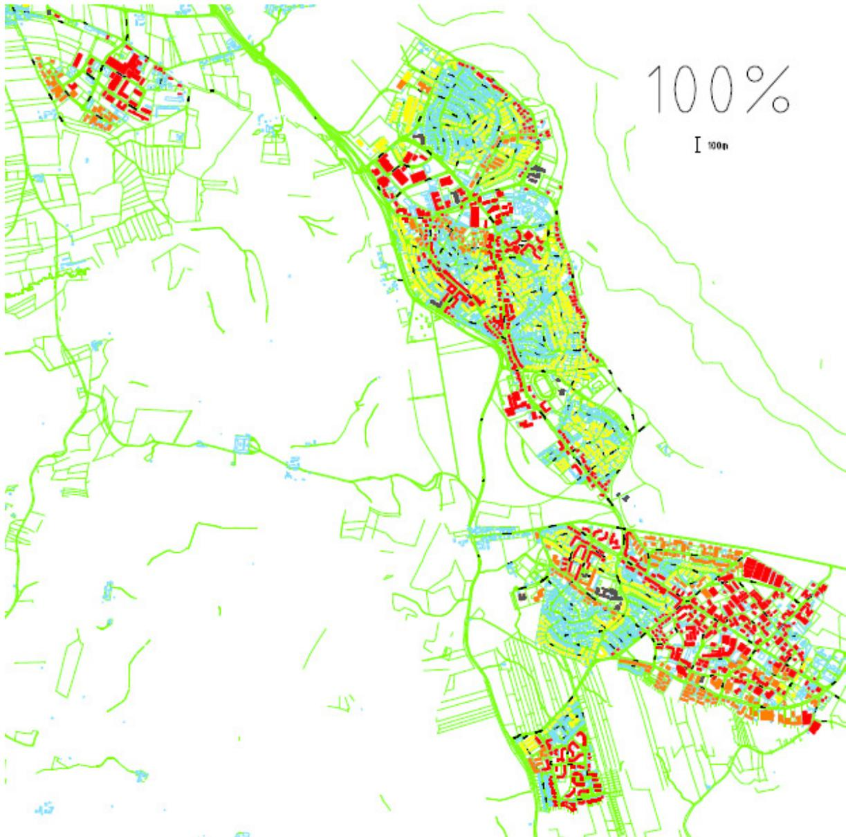
**Abbildung 76: Das Wärmekataster der Stadt Geretsried bei 100 % Anschlussdichte**
