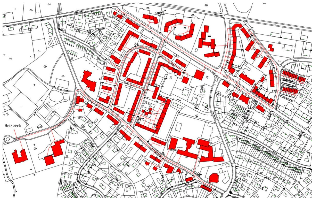
**Abbildung 98: Der mögliche Verlauf des Nahwärmeverbundnetzes „OT Geretsried“**
