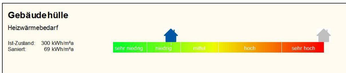
**Abbildung 139: Der Heizwärmebedarf der Baualterklasse II im modernisierten Zustand**
