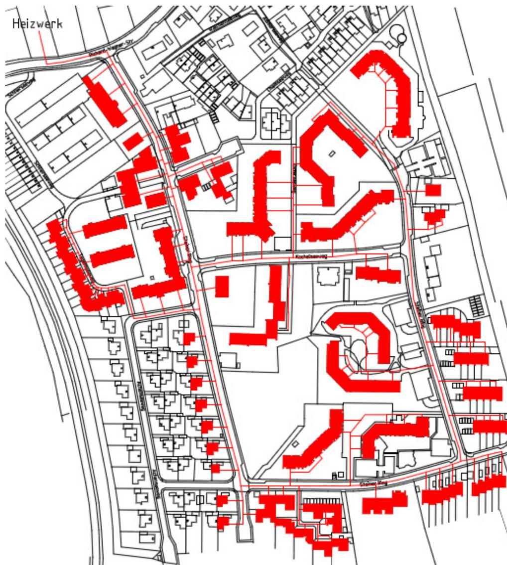
**Abbildung 88: Der mögliche Verlauf des Nahwärmeverbundnetzes „OT Stein“**
