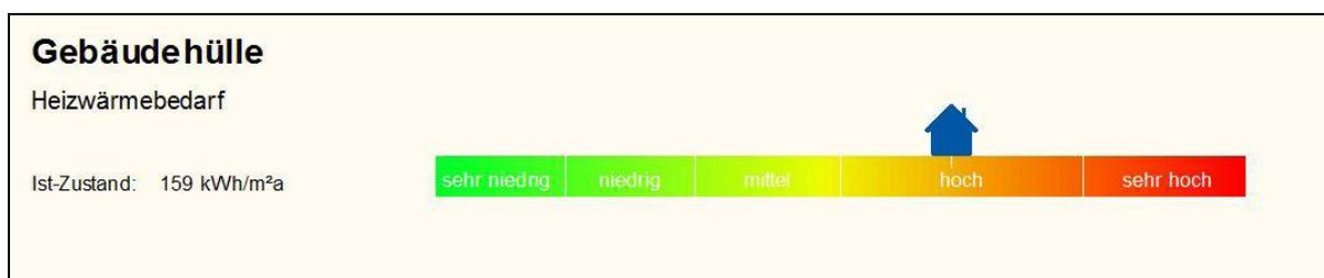
**Abbildung 144: Der Heizwärmebedarf der Baualterklasse V im Ist-Zustand**
